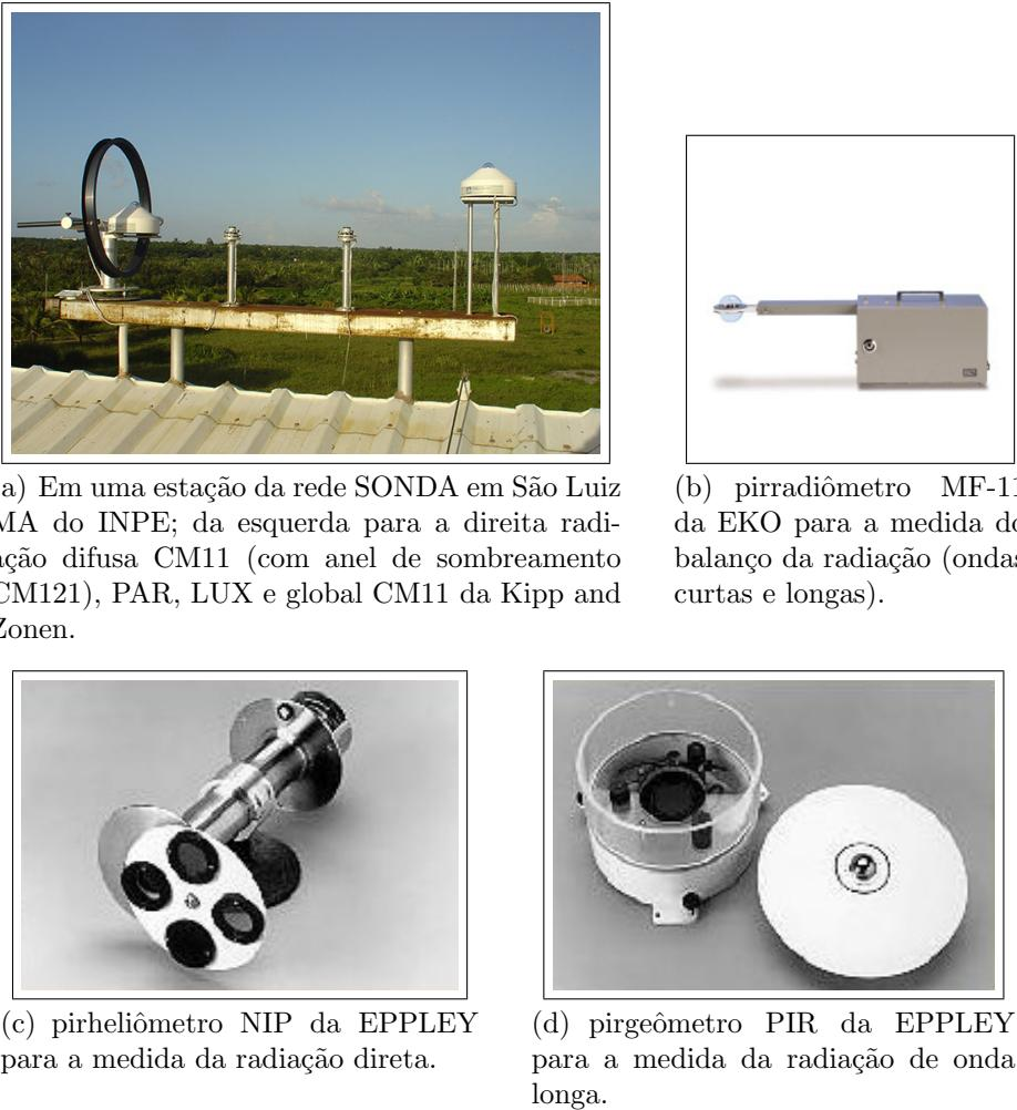
**Figure 2.3:** Exemplos de tipos de piranômetros que medem diferentes componentes da radiação solar.
